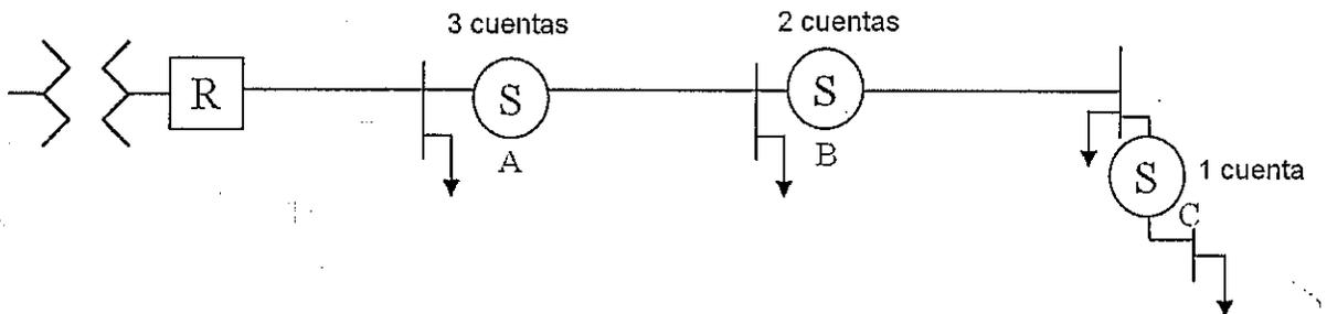
Para una falla aguas abajo del último seccionizador actúa el reconectador (R), y los 3 seccionizadores (A,B,C) cuentan las interrupciones de corriente. El seccionizador C, sin embargo, abre y aísla la falla al contar la primera operación del reconectador. El reconectador reenergiza el alimentador en las zonas no falladas, y los seccionizadores A y B se resetean, quedando habilitados para una proxima operación de conteo frente a fallas aguas debajo de ellos.
