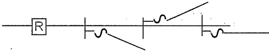
La curva rápida del reconectador es usada para despejar toda falla transiente que ocurra en el alimentador troncal y en sus laterales. Para fallas permanentes en los laterales la curva lenta del reconectador permite que el fusible despeje la falla, resultando sólo fuera de servicio el lateral que se encuentra en condición de fallas; lo anterior se ilustra en la fig. siguiente:
