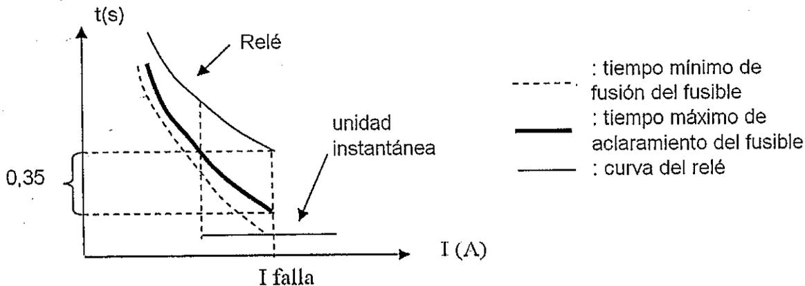
Fig. 4.6 Tiempo de aclaramiento del fusible
