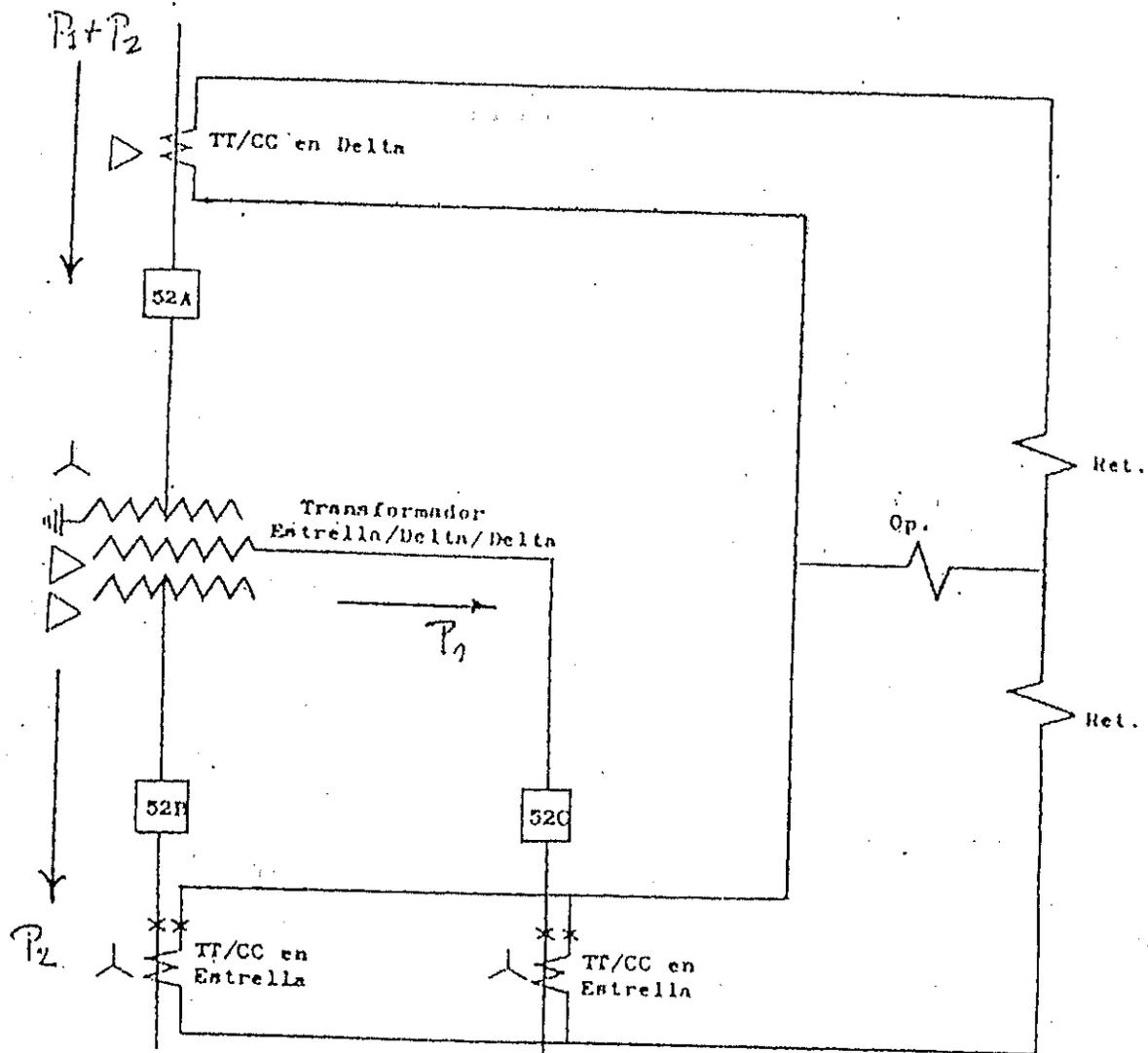
Fig. 5.30 Se supone fuente de potencial activa y reactiva solo en lado de A.T. (Y)
