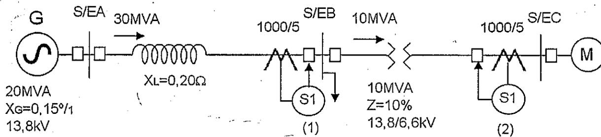
Para los cálculos elegimos  $S_B = 20$  MVA ,  $V_B = 13,8$  kV para el lado del generador y por tanto 6,6 kV del lado del motor.
