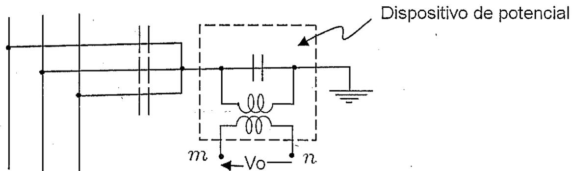
Fig. 5.21. Obtención de voltaje de polarización residual.
