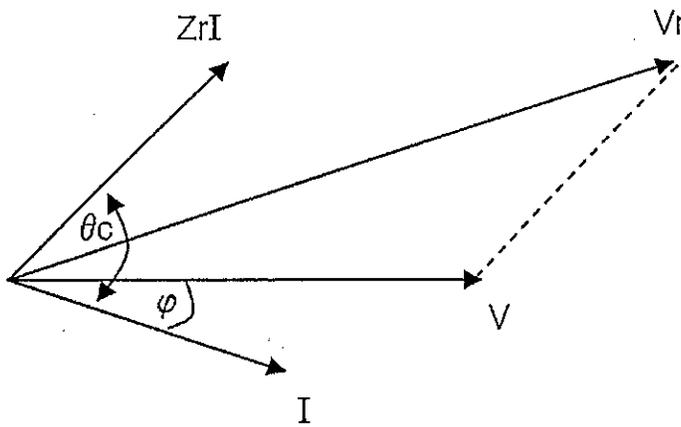
Fig. 5.40 Compensación de un relé de distancia.
