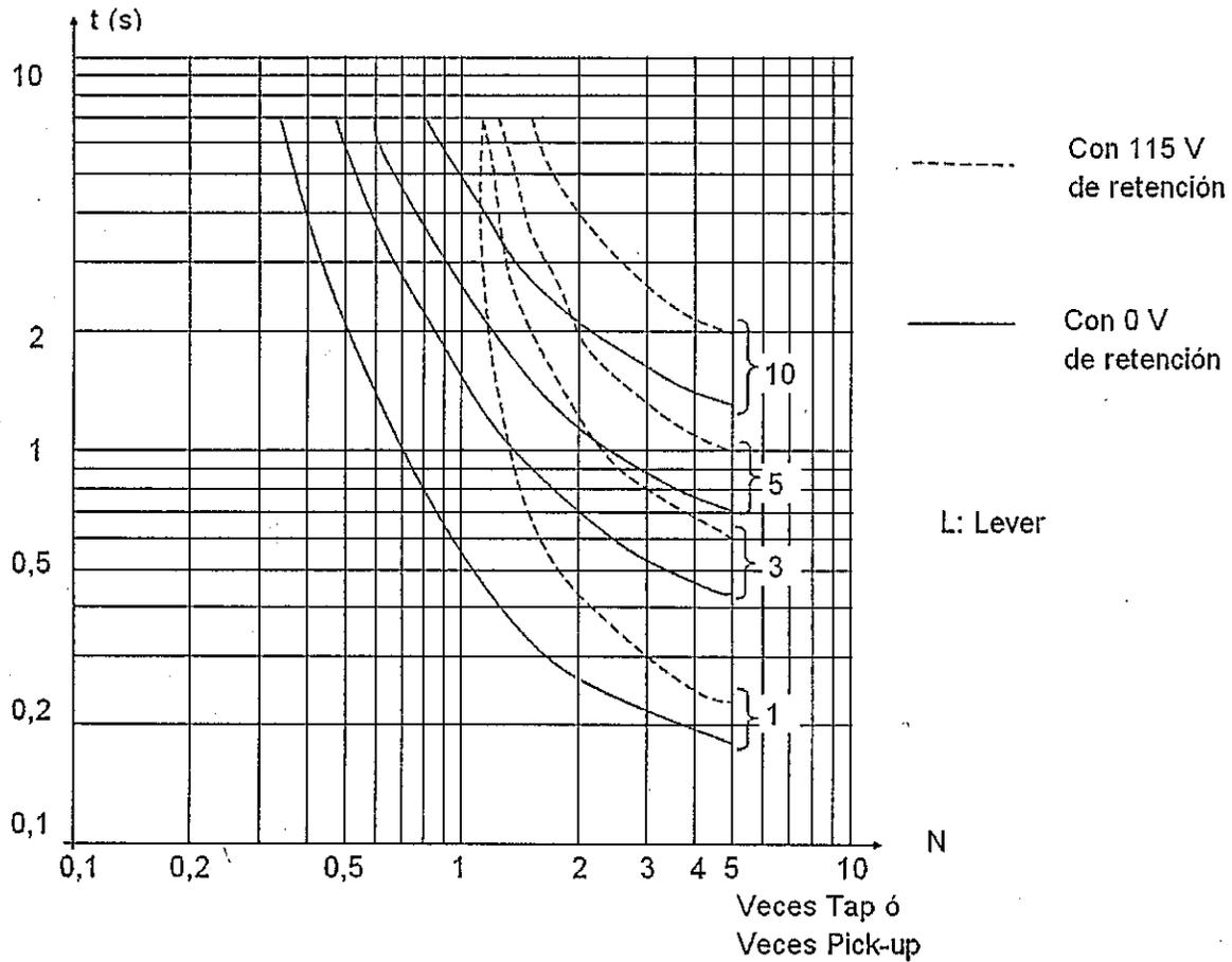
Fig. 5.16 Curvas de tiempo versus corriente en múltiplos de tap o pick-up.
