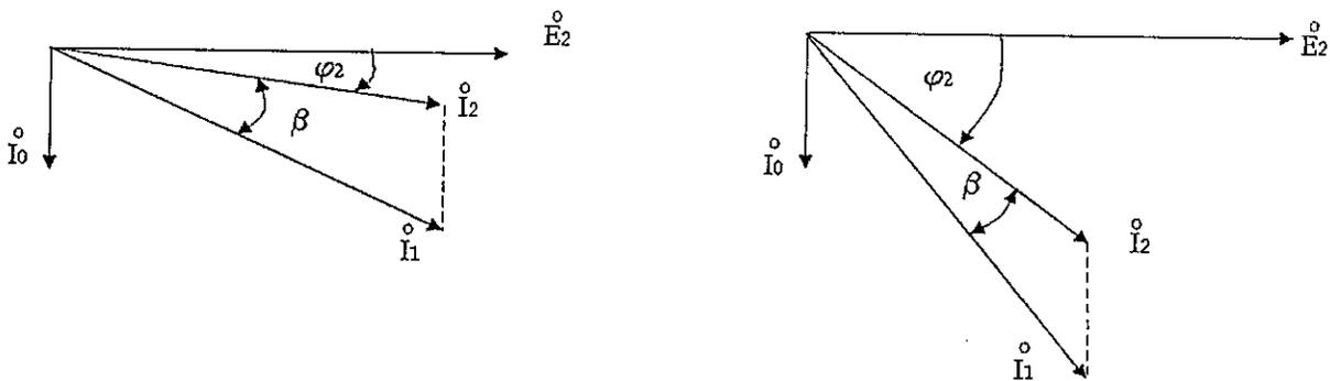
Fig. 2.10 Influencia del f de p de la carga en el error de razón y de ángulo.
