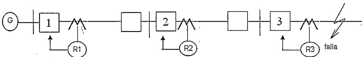
Fig. 5.12 Sistema Radial protegido con relés de sobrecorriente de tiempo inverso.
