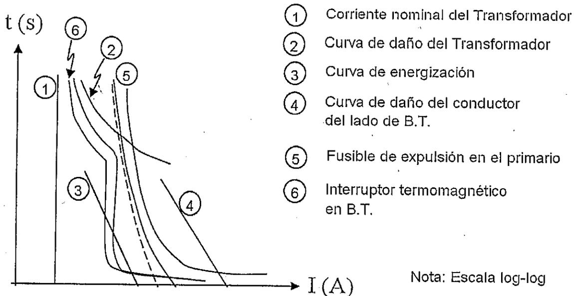
Fig. 4.11 Coordinación de Fusible con curvas de transformador.
