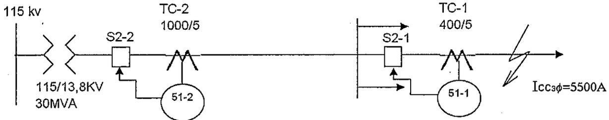
El Transformador de poder permite una sobrecarga del 25% alimentando la carga en el lado de 13,8 kV. Los TC de cada cono de los subalimentadores son de razón 400/5. los relés de sobrecorriente tienen taps disponibles de 4, 5, 6, 8, 10, 12 y 16 amperes. Las curvas tiempo corriente son las que se muestran a continuación.
