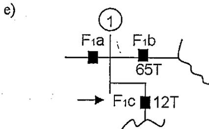
Dado que  $F_{1a} = 50$  T del que es de menor capacidad al que  $F_{1b} = 65$  T se debe especificar para  $F_{1a}$  un fusible 100 T el que da respaldo a  $F_{1b} = 65$  T hasta 3200 A y al  $F_{1c} = 12$  T hasta  $I_{cc} = 6100$  A.
