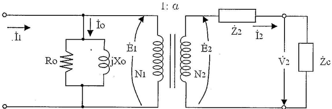
Fig. 2.3 Circuito equivalente con Transf. Ideal (T.I.)
