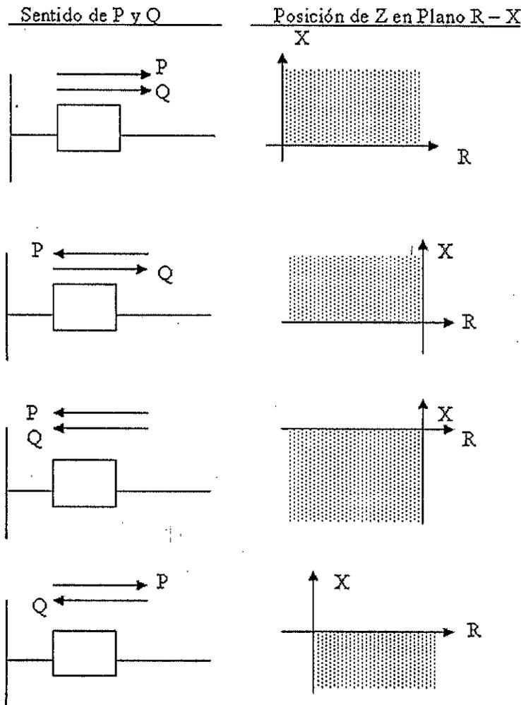
Fig. 5.43 Posiciones de Z de acuerdo a la dirección del flujo de P y Q.
