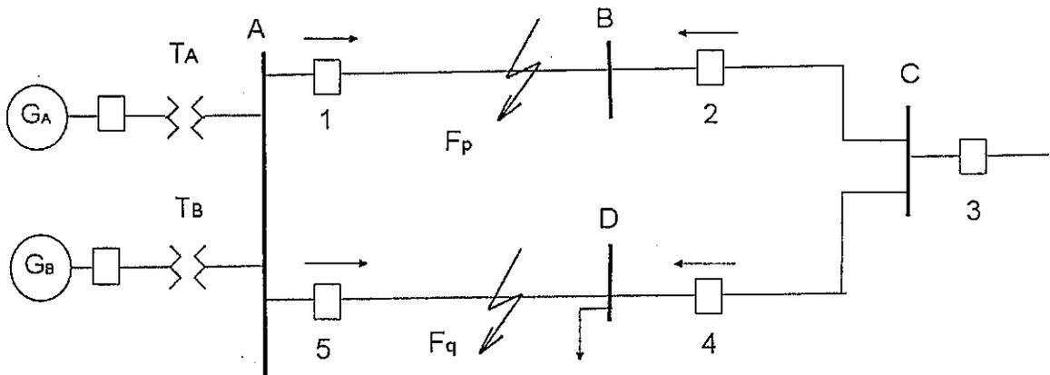
Fig. 5.18 Protecciones Direccionales en SEP en Anillo.
