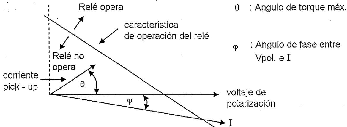
Fig. 5.16 Características Operacional de un Relé Direccional en Coordenadas Polares.
