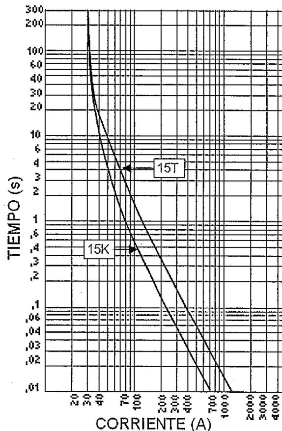
Fig. 4.1 Curva de Tiempo mínimo de fusión para fusible rápido (K) y lento (T) de la misma capacidad.
