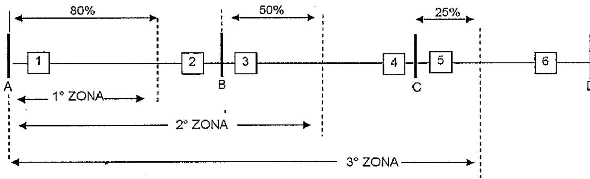
Fig. 5.45 Definición de Zonas para Protecciones de Distancia
