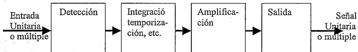
Fig. 2.20 Representación lógica de un relé eléctrico.
