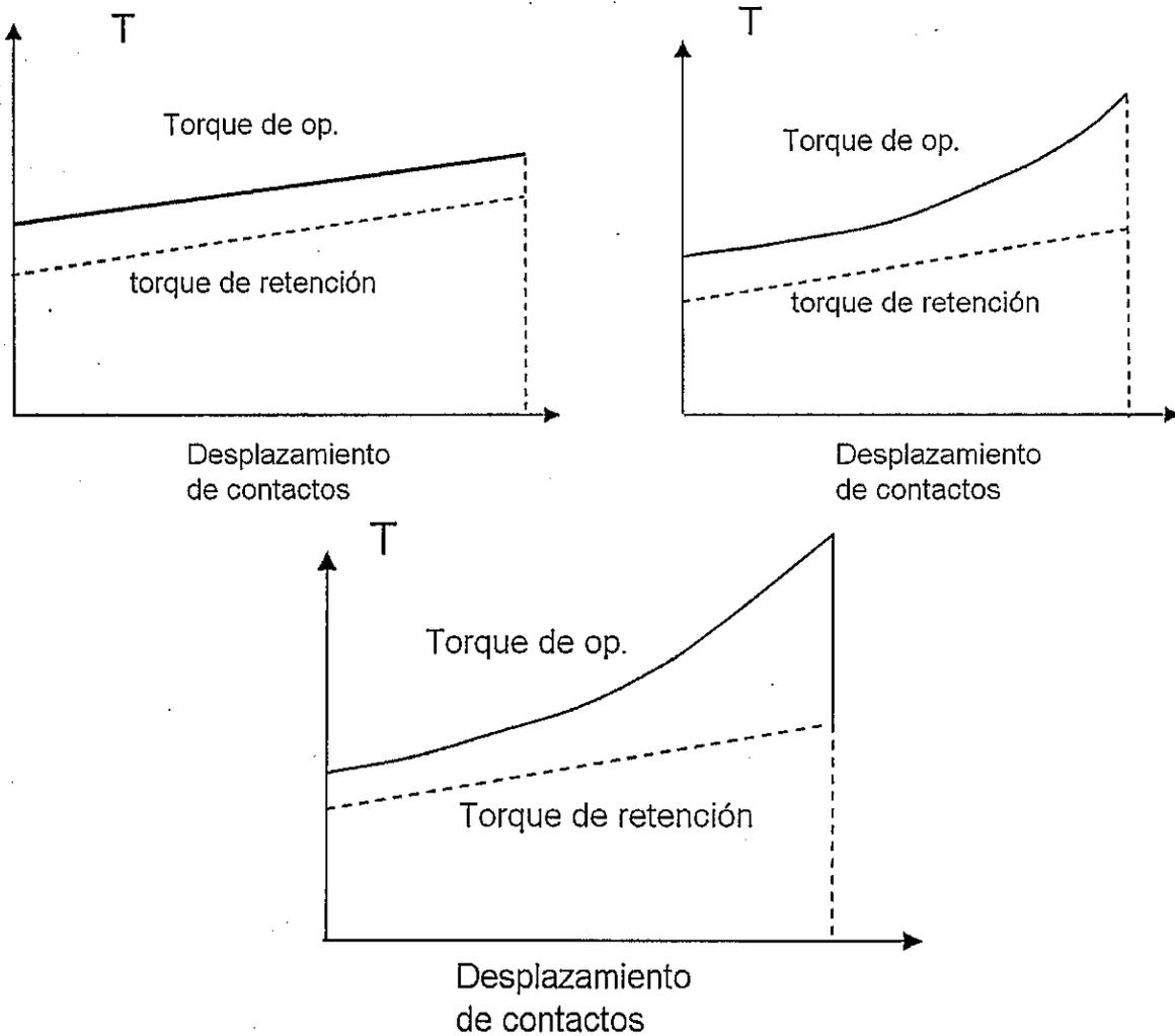
Fig. 2.24 Característica de Torque de distintos tipos de Relé electromagnéticos.
