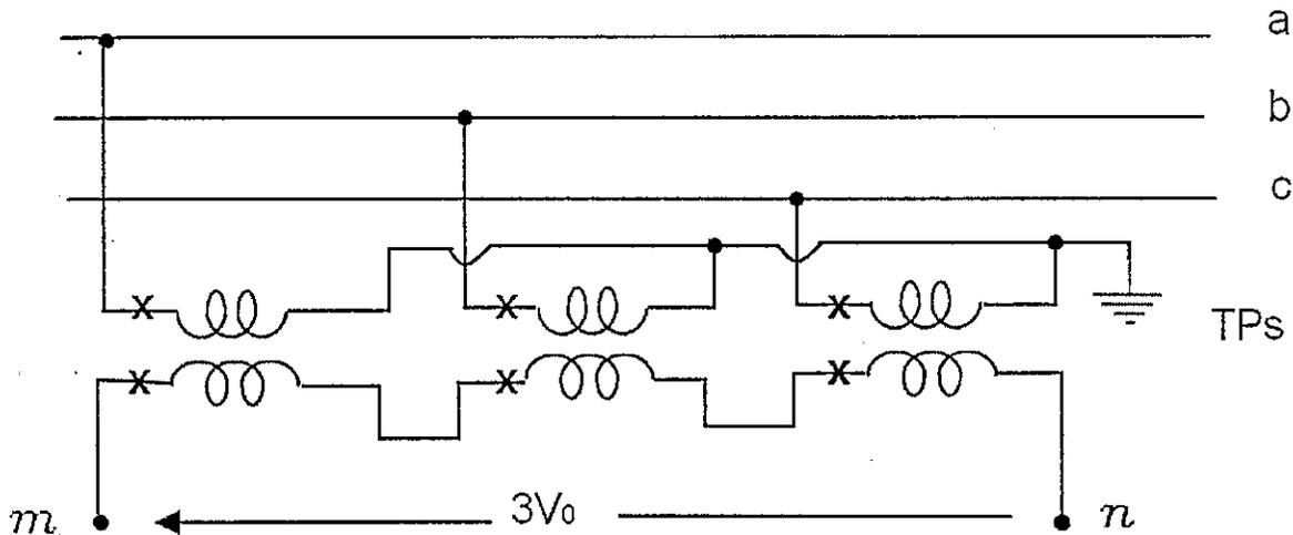
Fig. 5.20. Conexión de TPs para obtener Voltaje Residual.
