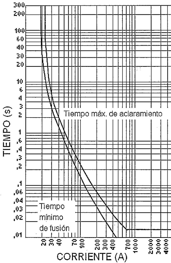
Fig.4.2 Curva tiempo - corriente para fusibles 10 K
