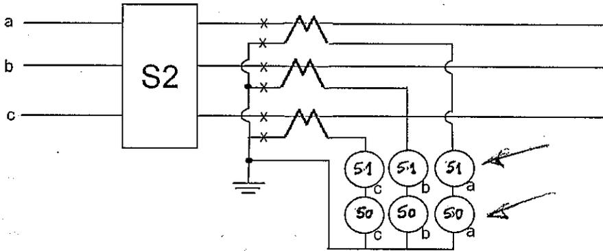
Fig. 5.14. Conexión de relés de sobrecorriente de tiempo inverso e instantáneos.
