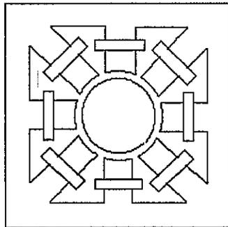
Fig. 2.23 Relé de cilindro de Inducción
