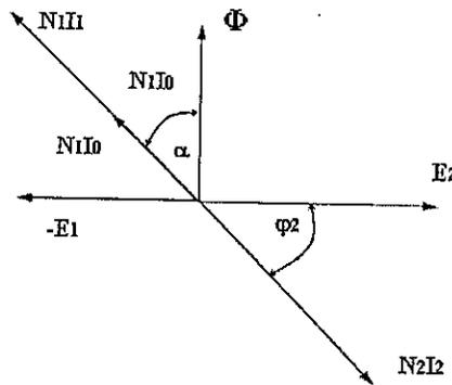
Fig. 2.6 Diagrama Fasorial para error de ángulo cero.
