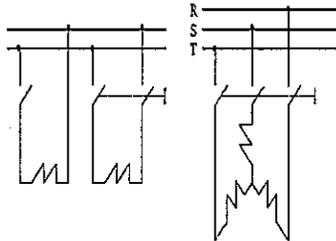
Para lograr aislar por completo un receptor o una instalación cualquiera, es necesario abrir el circuito por tantos puntos como conexiones tenga con la línea que lo alimenta. Así, pues, los interruptores unipolares solamente se utilizarán en pequeños receptores de uso doméstico, debiendo utilizar en los demás casos interruptores con tantos polos como conductores lo alimentan.
