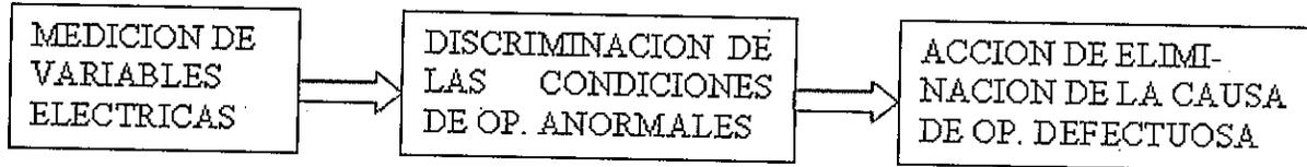
En el caso más frecuente de un S.E.P, un sistema de protecciones eléctricas según el esquema anterior, está constituido por:
