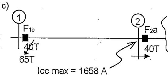
Dado que  $F_{2a}$  se establece como 40 T, y siendo  $F_{1b}$  un 40 T, se debe obtener  $F_{1b}$  tal que de respaldo a  $F_{2a}$ . Así, de acuerdo a la tabla de coordinación se obtiene que  $F_{1b}$  debe ser 65 T el que da respaldo a  $F_{2a}$  hasta para  $I_{cc\ max} = 3100$  A en barra 2 la que es mayor que  $I_{cc\ max}$  en dicha barra de 1658 A.
