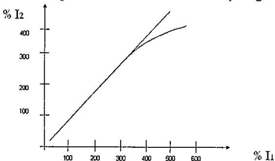
Fig. 2.8 Efecto de la saturación del núcleo.
