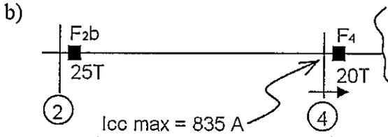
Según tabla de coordinación. El fusible 25 T no respalda al fusible 20 T, en consecuencia se debe subir el fusible de respaldo al siguiente en la serie, esta es al 30 T, el que respalda hasta  $I_{cc\ max} = 990$  (A) en barra 4, corriente que es mayor que 835 A de  $I_{cc}$  máximo en barra 4.
