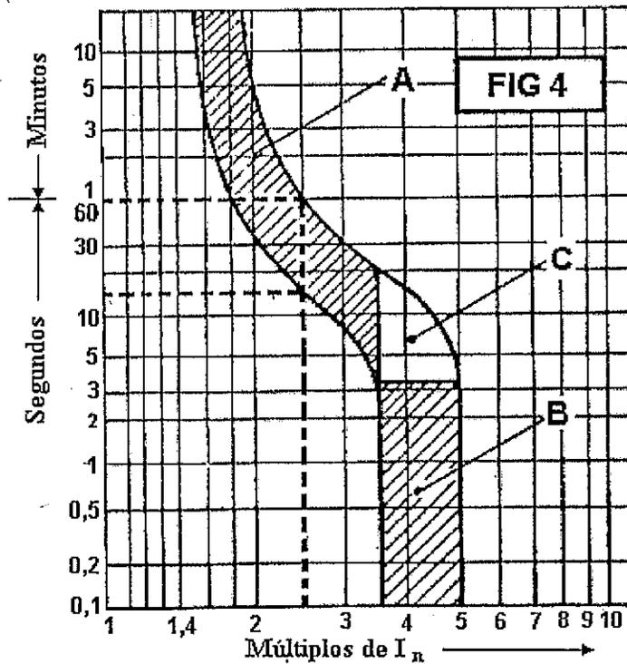
En el gráfico de la figura 4. puede verse la curva de desconexión de un magneto-térmico, en la que se aprecia una zona A, claramente térmica, una zona B que corresponde a la reacción magnética, y la zona de solape C, en donde el disparo puede ser provocado por el elemento magnético o térmico indistintamente.
