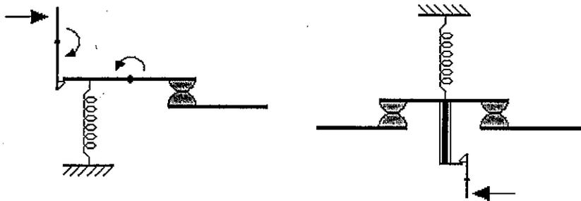
Si en lugar de un único par de contactos, disponemos de dos pares de contactos en serie, mecánicamente unidos, tal y como se muestra en la figura, conseguimos duplicar el arco, lo cual equivale a decir que la velocidad de corte se ha duplicado, o lo que es igual, el tiempo y el trabajo de ruptura se han reducido a la mitad. Esta es la disposición que adoptan la mayor parte de los interruptores denominados "contactores".
