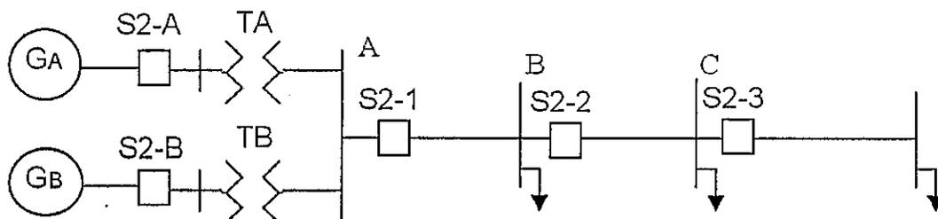
Fig. 5.5. Sistema de Distribución Radial.
