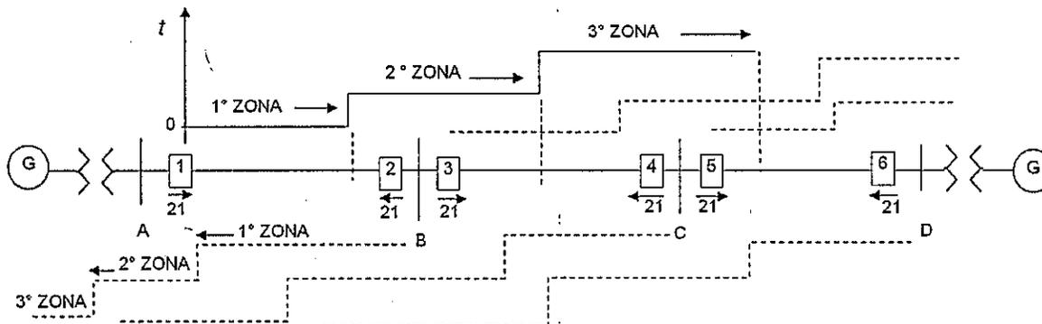
Fig. 5.46 Definición de las Zonas de Operación de los relés de distancia de un sistema Interconectado.
