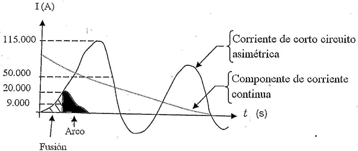
Fig. 2.29 Representación de las corrientes RMS y picos indicadas en la fig. 2.28 en la onda de corriente de corto circuito para un fusible limitador.
