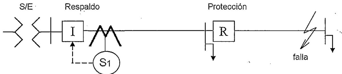
Una adecuada coordinación entre ambos se logra cuando el reconectador (R) opera debido a una falla en el lado de la carga, impidiendo que opere el interruptor (I) comandado por el relé de sobrecorriente (S1) es decir, que la curva característica del reconectador no cruza con la del relé, dejando un tiempo mínimo de 0,35 segundos y eliminando el ultimo recierre del reconectador.
