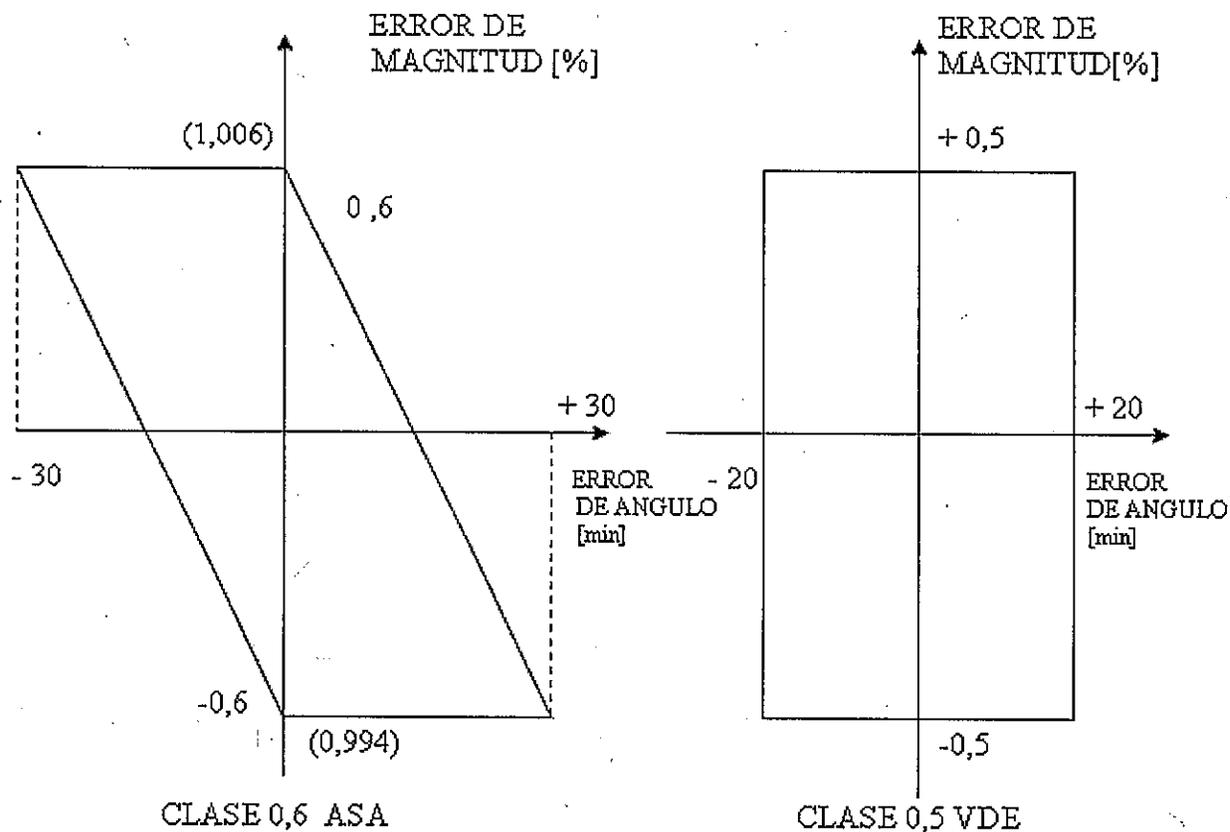
Fig. 2.19 Representación de clases de Precisión.
