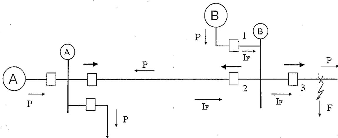
Fig. 5.17. Protecciones de sobrecorriente direccional en un SEP.
