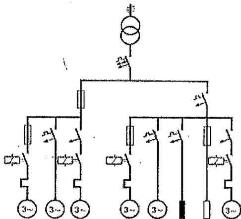
Así, según vemos en la figura, inmediatamente después del transformador tenemos un interruptor automático, dividiéndose el circuito en dos ramales, con sendas derivaciones a motores y resistencias de calefacción. Hasta llegar a los receptores, existen una serie de
