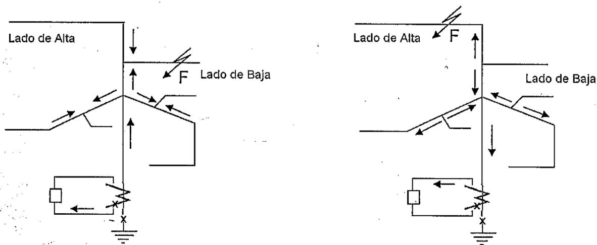
a) Autotransformador con falla en lado de Baja
