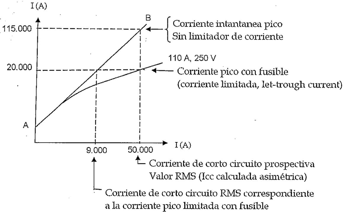
Fig. 2.28 Curvas de limitación de corriente para fusibles limitador.
