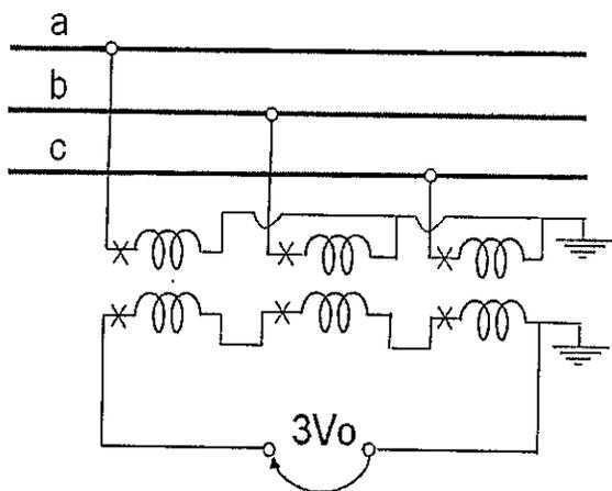
Fig. 2.1. Medición de Voltaje de Secuencia cero
