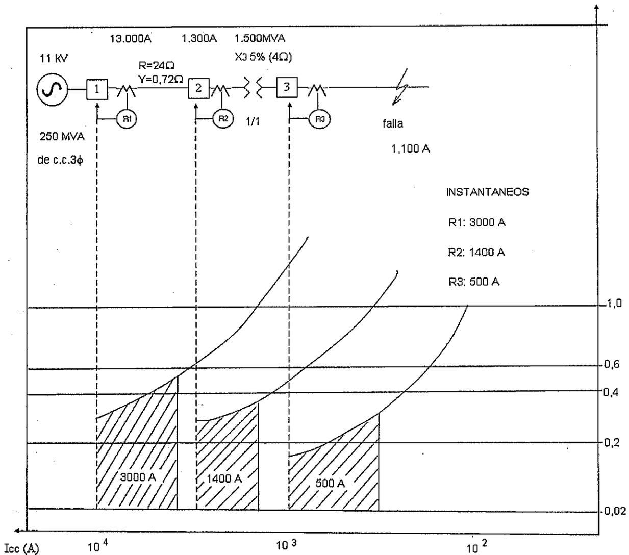
Fig. 5.13. Ejemplo de Ajuste de Elementos Instantáneos
