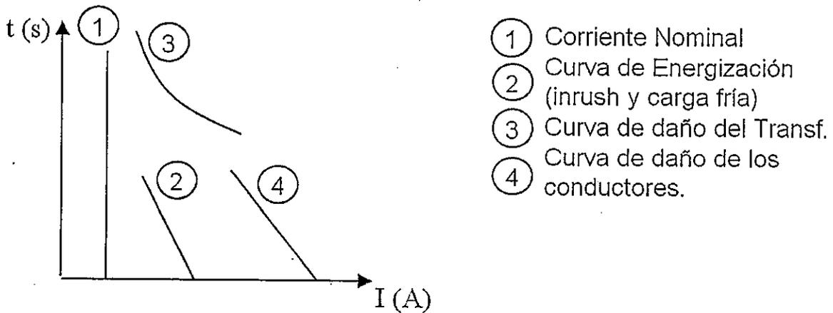
Fig. 4.10 Curvas de Transformador
