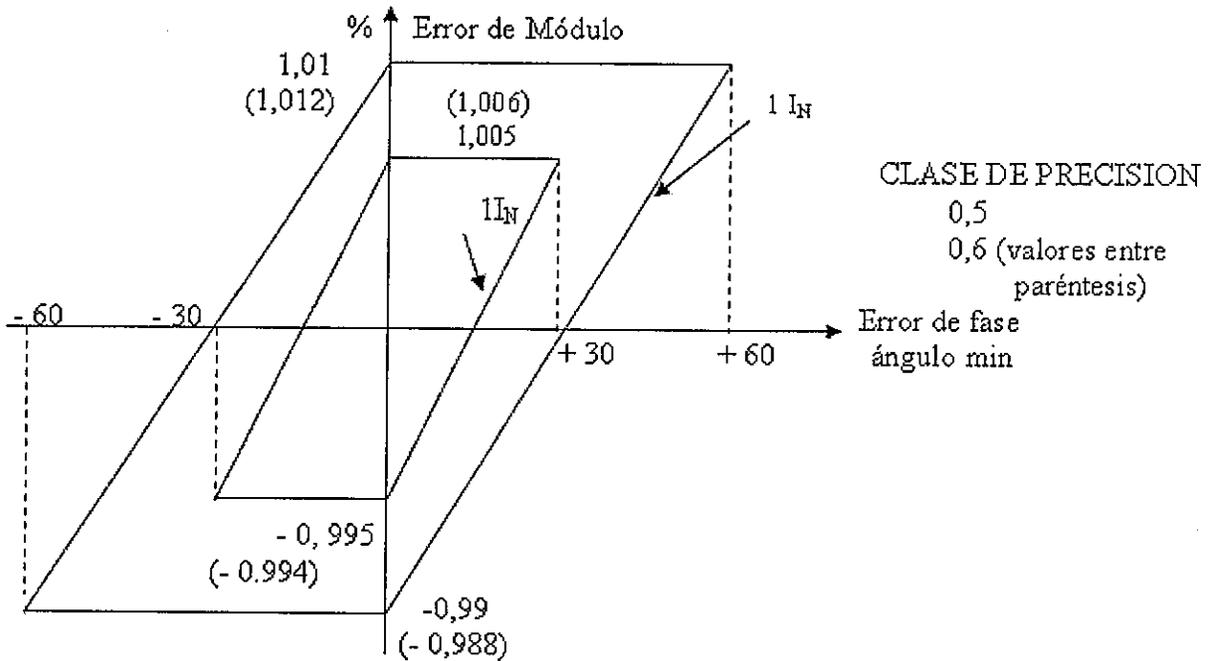
Fig. 2.12 Clase de Precisión según ASA.
