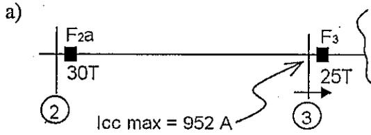
Según tabla de coordinación. El fusible 30 T no da respaldo al fusible 25 T. En consecuencia se debe subir al fusible de respaldo a la serie siguiente, esto es 40T, el que da respaldo hasta una  $I_{cc\ max}$  de 1400 A en barra 3.
