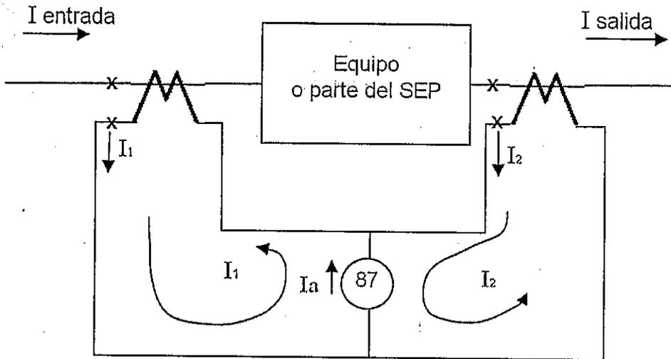
Fig. 5.24 Esquema de conexión de un relé diferencial.
