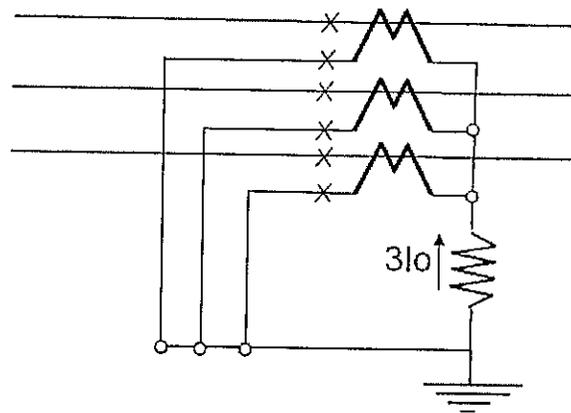
Fig.2.2. Medición de Corriente de Secuencia cero.
