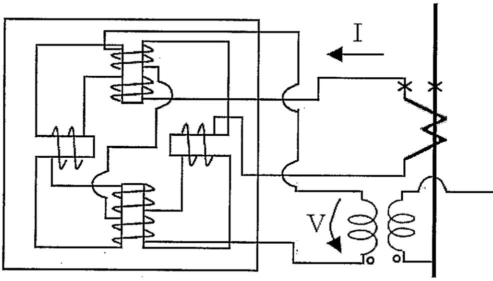
Fig. 5.14. Alimentación bobinas de I y V de Relé con retención de tensión.
