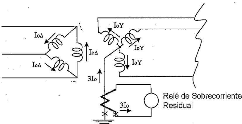
Fig. 5.10. Conexión de un Relé residual en el neutro de la estrella de un transformador
