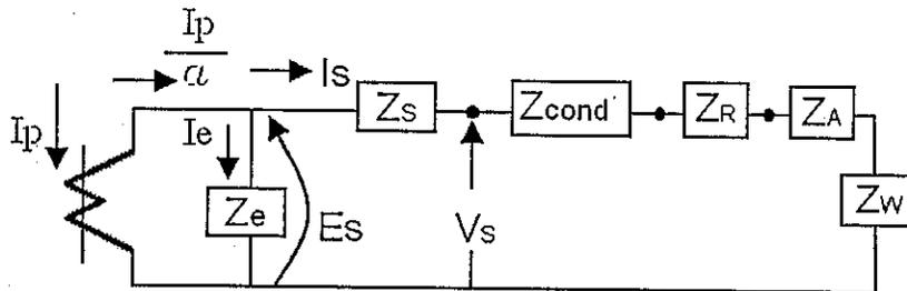
Para el conductor N° 10 AWG, de tabla :  $R = 3,34 \frac{\Omega}{km}$ ,
