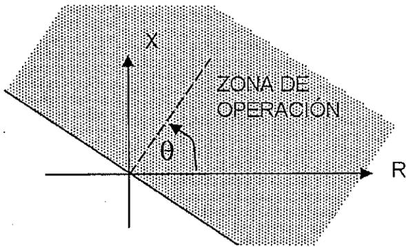
Fig. 5.44 Características de operación de un relé direccional en el plano R-X.
