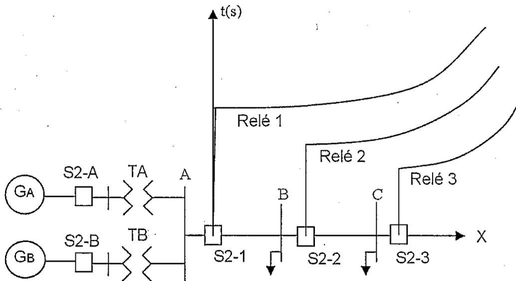
Fig. 5.7. Sistema de Distribución Radial con Protección de Sobrecorriente de Tiempo Inverso
