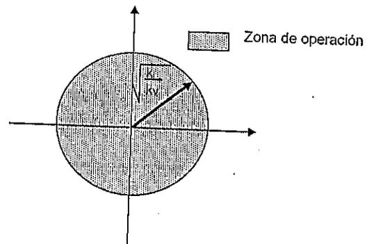
Fig. 5.37. Característica de operación del relé de Impedancia
