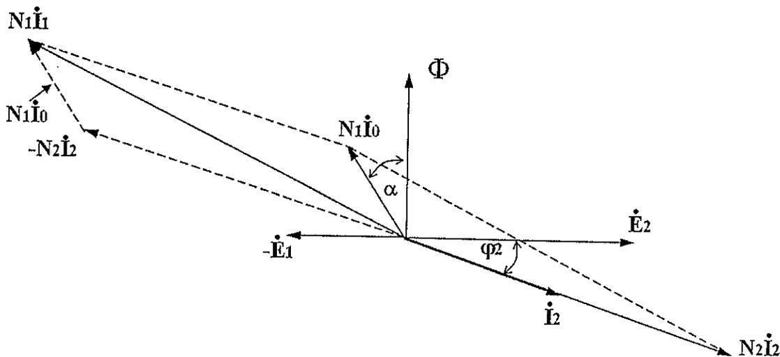
Fig. 2.5.- Diagrama Fasorial de un T.C.
