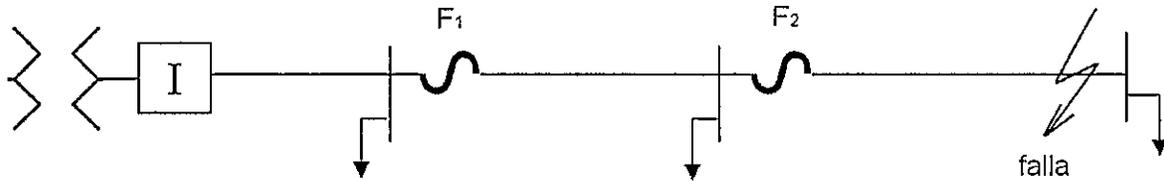
Para lograr una coordinación entre fusibles se utilizan las curvas de tiempo mínimo de fusión y tiempo máximo de desjeje de cada fusible ( $F_1$  y  $F_2$ ), de modo que para una falla, aguas abajo del fusible  $F_2$  debe operar este antes que opere el fusible  $F_1$  o se presente algún daño en el (elemento protegido o de respaldo), el cual debe operar únicamente como respaldo o para alguna otra falla entre ambos.
