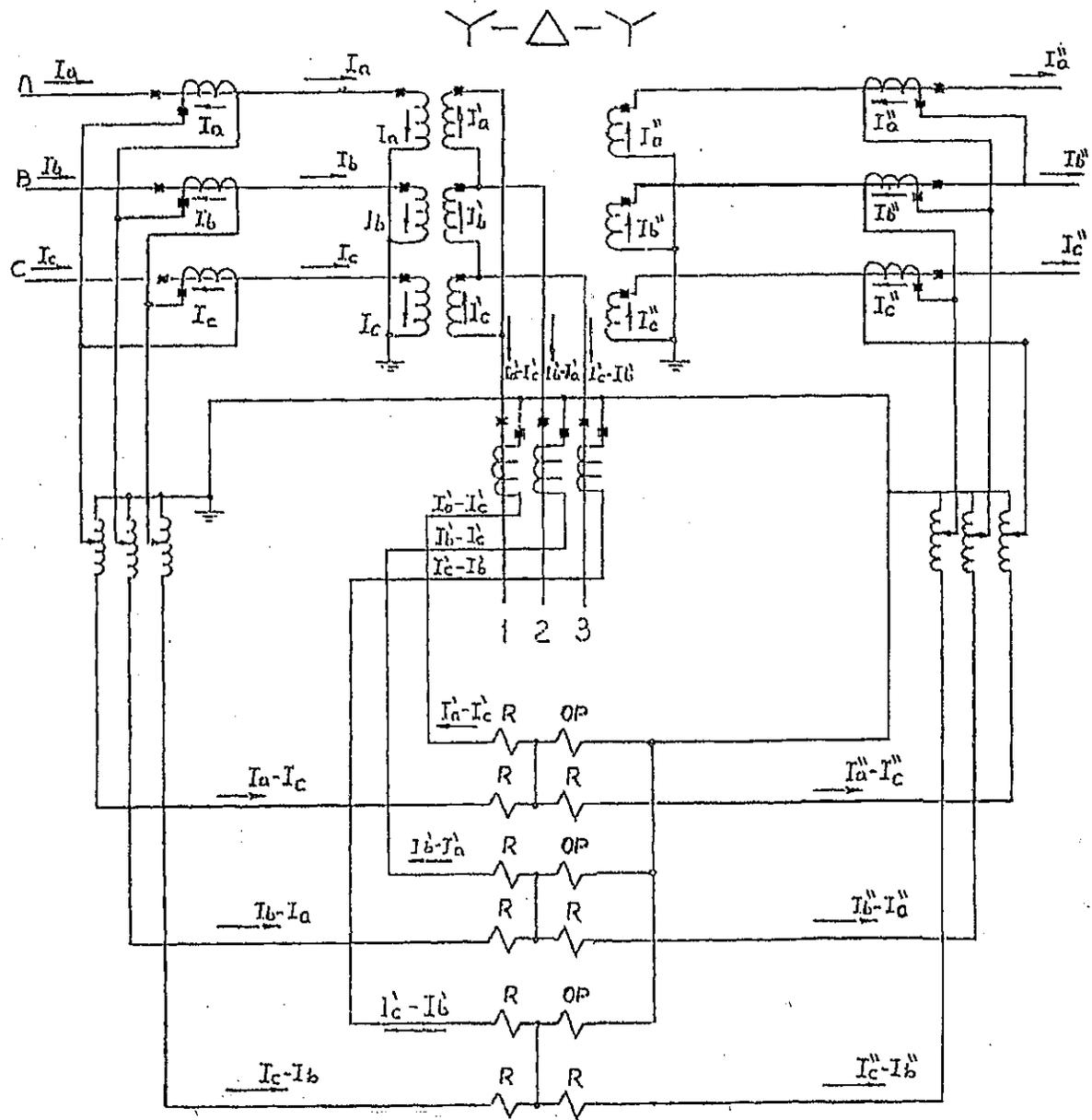
Fig. 5.29 Esquema de proteccion diferencial para un transformador de tres enrollados, estrella -delta - estrella
