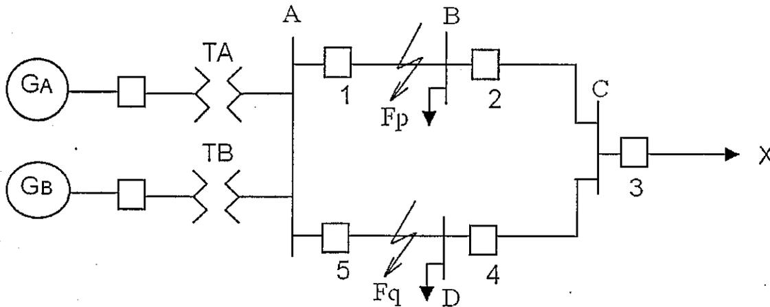
Fig. 5.8. Sistemas de Distribución o transmisión en Anillo
