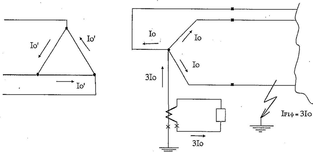
Fig. 5.22. Obtención de la corriente de polarización residual en un Transf.  $\Delta/Y_{\text{neutro}}$ .
