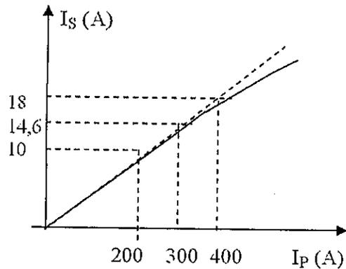
Fig. 2.13 Curva de Saturación
