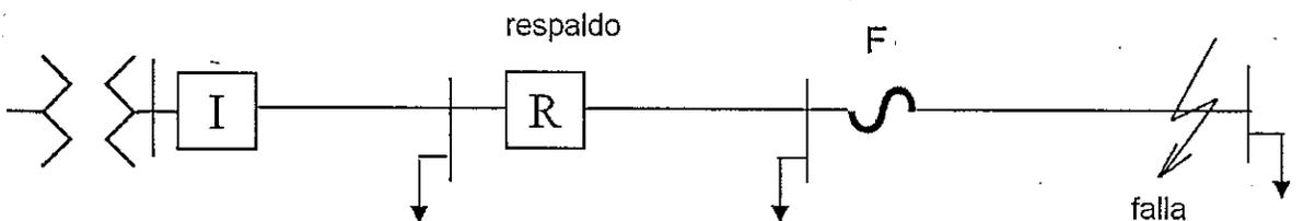
En este esquema se busca que las operaciones rápidas del reconectador (R) no provoquen daño a los fusibles (F), incluyendo el efecto acumulativo de las operaciones.
