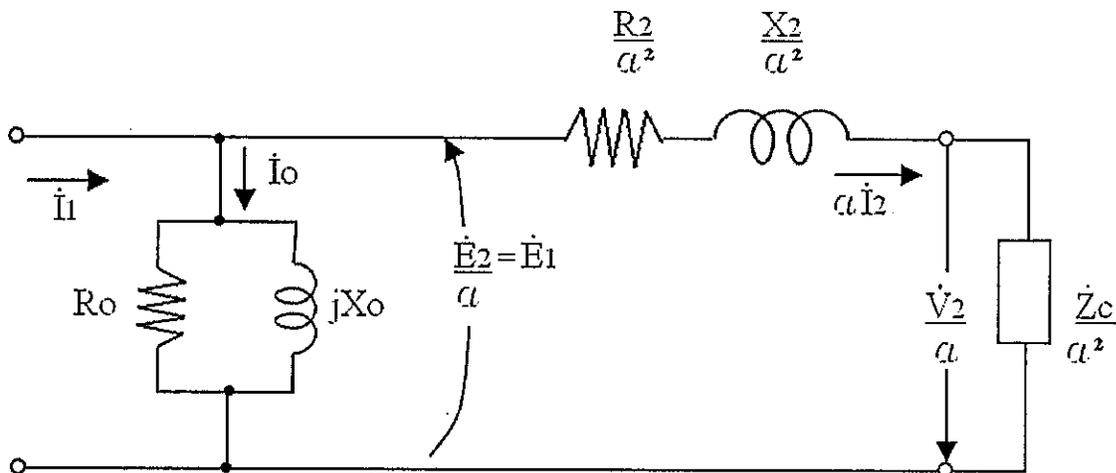
Fig. 2.4 Cto. equiv. aproximado referido al primario
