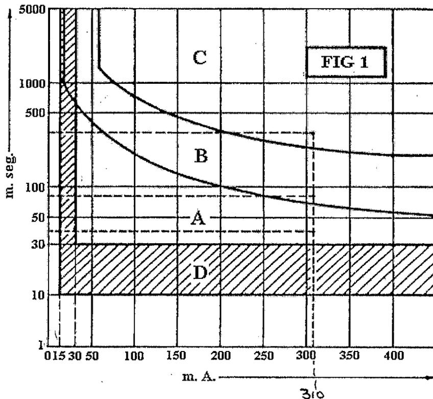
La intensidad circulante por el cuerpo humano viene limitada por una parte, por la resistencia propia del cuerpo (unos 550 ohmios mínimo) y por otra, por la resistencia del contacto con las zonas en tensión. Para el caso más desfavorable de resistencia del cuerpo y suponiendo un contacto perfecto, la intensidad circulante será máxima.
