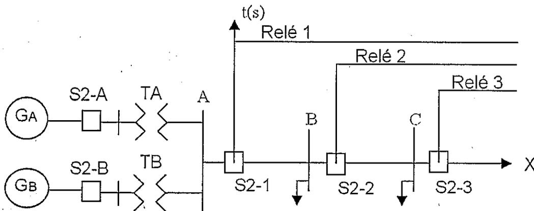
Fig. 5.6. Sistema de Distribución Radial con Protección de Sobre Corriente de Tiempo Definido.
