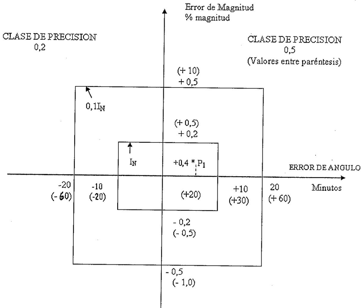
Fig. 2.11 Clase de Precisión según VDE
