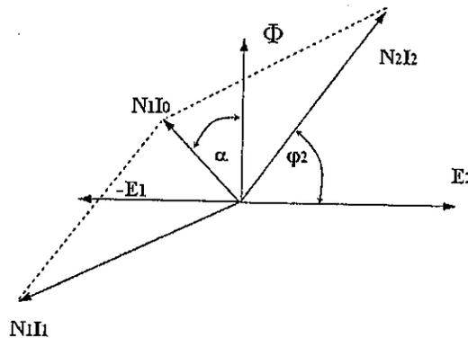
Fig. 2.7 Diagrama Fasorial para error de razón cero y error de ángulo máximo.
