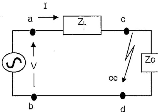
De acuerdo a lo anterior, para la figura 5.35 siguiente se cumple que  $Z = \frac{V}{I} = Z_L + Z_{carga}$  en condiciones de operación normal, pero cuando ocurre un corto circuito entre c y d, la impedancia medida entre a y b es:  $Z = \frac{V}{I} = Z_L$ .
