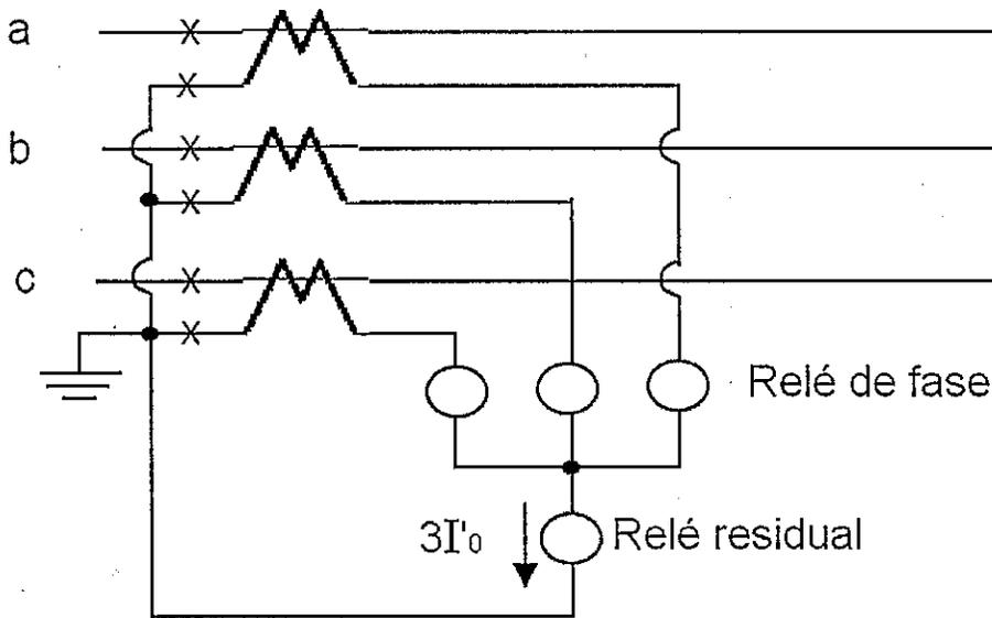
Fig. 5.9. Conexión de un rele residual de sobrecorriente
