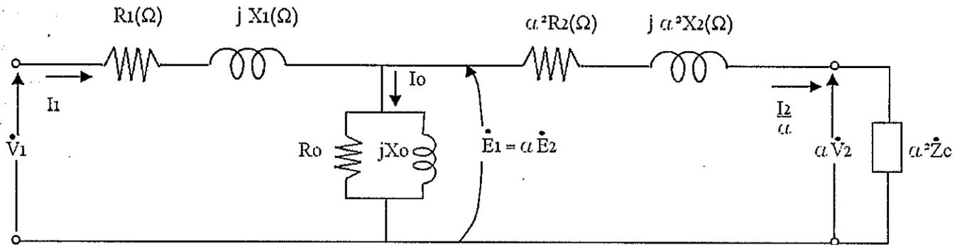
Fig. 2.1.7. Cto. equivalente TP referido al primario
